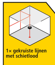
Hellingsgraad +/- 10% met verticaal punt en schietlood
