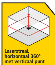
Laserstraal met horizontale rotatie van 360°
