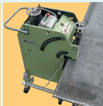
Chaflanado en chapa larga avanzado sobre carro. CHP-21G REV girando. Beveling large pieces moving forward on the trolley. CHP-21G REV turning around. Chanfreinage de grandes pièces avançant sur le chariot. CHP-21G REV tournant autour.
