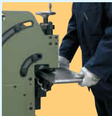
Chaflanado de piezas pequeñas multiformes. Beveling multi-form little parts. Chanfreinage de petites pieces multiformes.
