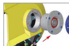
Gruppo flangia con cuscinetti conici contrapposti a sostegno del volano motore, soluzione che permette di preservare il riduttore dagli sforzi causati dalla tensione della lama e quindi di garantire una lunga vita.
