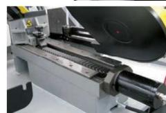
Morsa chiusura materiale a posizionamento manuale con sistema di scorrimento rapido a cremagliera e cilindro di bloccaggio idraulico.
