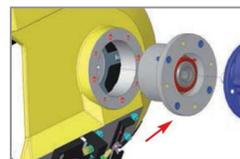
Gruppo flangia con cuscinetti conici contrapposti a sostegno del volano motore, soluzione che permette di preservare il riduttore dagli sforzi causati dalla tensione della lama e quindi di garantirne una lunga vita.
